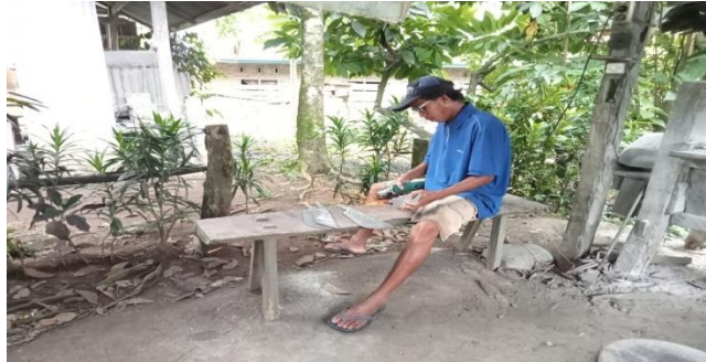
Gambar 4.4 Proses Menggurindra Parang
