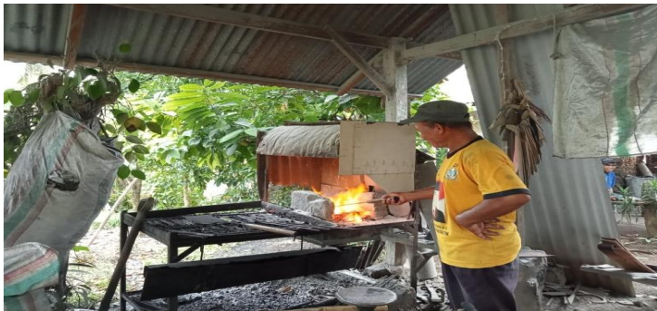
Gambar 4.5 Proses Pemanasan Besi
